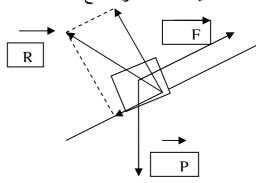
$\overrightarrow{F} + \overrightarrow{R} + \overrightarrow{P} = m.\overline{a}$  تطبیق القانون الثانی لنیوتن Fx + Rx + Px = m. ax :ox اسقاط العلاقة على المحور  $F = f + m.a + m.g.sin\alpha$  ومنه  $F - f - m.g.sin\alpha = m.a$  $F = 500 + 1200.2 + 1200.9.80.\sin 20 = 4.94.10^3 N$  :  $\pm 3.3$ 2- در اسة حركة المجموعة S في مجال الثقالة المنتظم:
